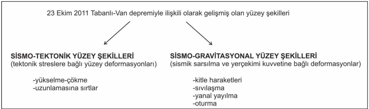
Şekil 4. 23 Ekim 2011 Tabanlı-Van depremi sırasında gelişen yüzey deformasyonlarının sınıflaması.
